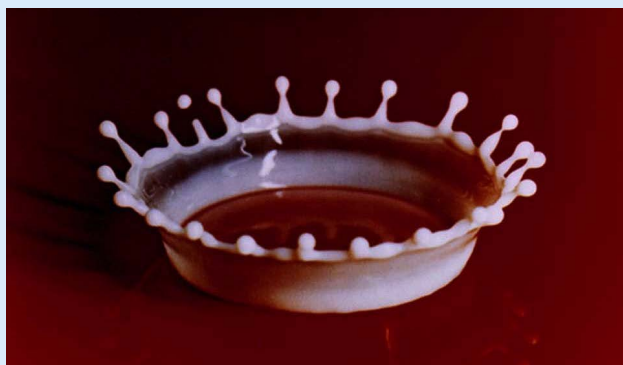
Fotografia ultra-rápida ilustrando uma fase da queda de uma gota de leite sobre uma superfície. Trata-se de uma foto célebre, obtida por Harold Edgerton em torno de 1938, utilizando equipamento especial por ele elaborado, e que deu início ao desenvolvimento da estroboscopia e suas variadas aplicações
