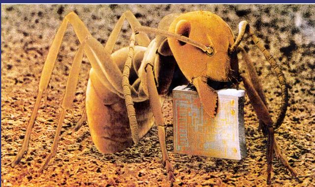
Na fotografia, uma formiga de 6 mm de comprimento mantém em suas mandíbulas um *microchip* de 1 mm<sup>2</sup>. A dimensão do menor circuito impresso constante do *microchip* da figura é de 300 nanômetros. ou seja, 300 bilionésimos de metro (1 nanômetro é igual a 1 milionésimo de milímetro).
