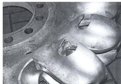
Erosão em pás de turbina Pelton
