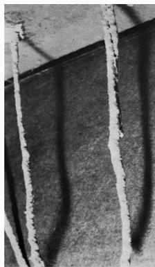
Figura 2 – Cordões expostos durante 700 horas à solução em gotejamento
