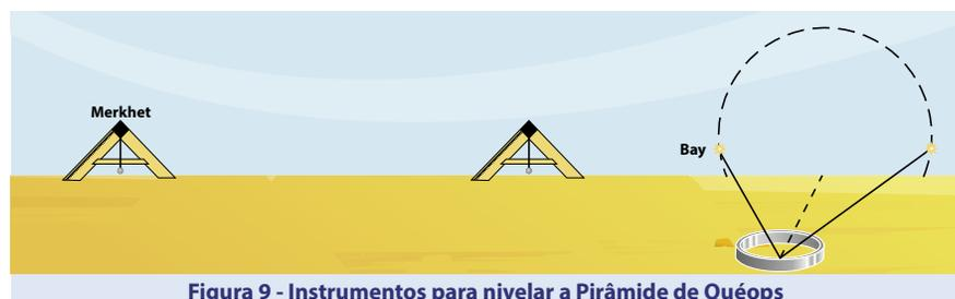
Figura 9 - Instrumentos para nivelar a Pirâmide de Quéops
