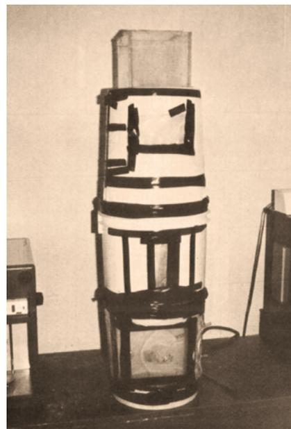
Figura 1. Equipamento utilizado para assegurar um ambiente úmido em torno da área de precipitação.
