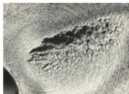
**Ampliação da região cavitada do corpo de prova anterior.**
